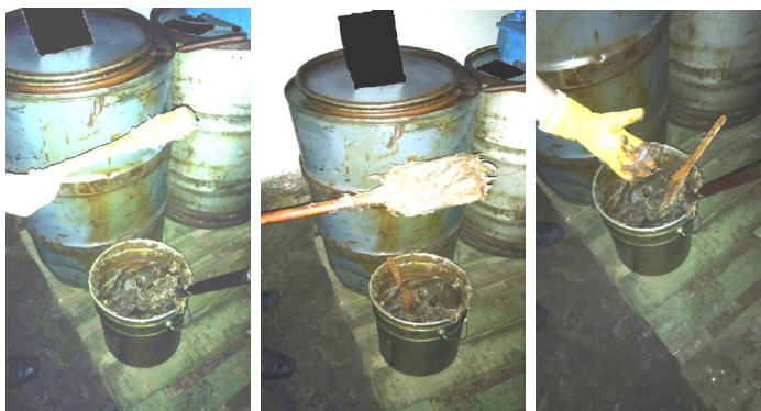
Рис. 1. Видача пластичних мастил за допомогою підручних засобів
