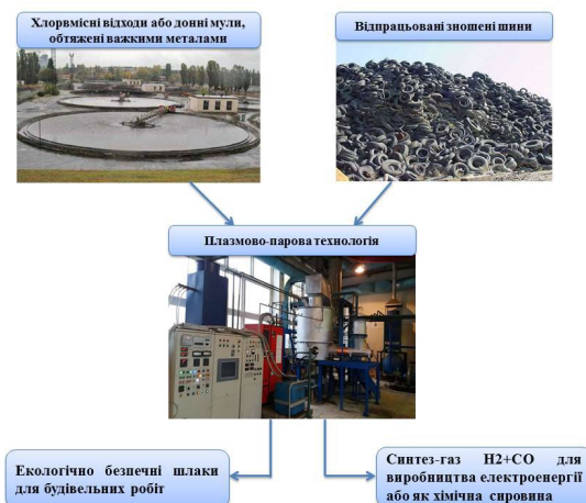
Рис. 1. Виробництво водню на основі плазмово-пароокисневого газифікації небезпечної відновлюваної сировини
