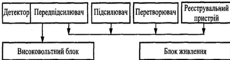
Рис.1. Структурна схема установки реєстрації іонізуючого випромінювання
